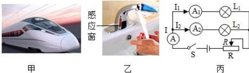
(1) 高铁的车头设计成如图甲所示的子弹头型，目的是减小\_\_\_\_\_；如图乙是车上的红外线感应水龙头，感应窗发出的红外线照到手上发生了光的\_\_\_\_\_现象，使感应窗内的红外线接收管收到信号后控制出水。
